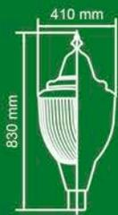
**Portabalastro:** Fabricado en fundición de aluminio moldeado en arena y pintado.
