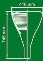
**Portabalastro:** Fabricado en fundición de aluminio moldeado en arena y pintado.
