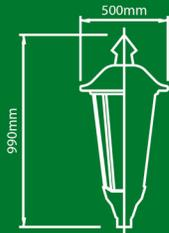
**Cuerpo:** Fabricado en fundición de aluminio moldeado en arena y pintado.
